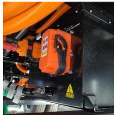
Como se muestra la figura se debe remover este conector, para desconectar todo el circuito de alto voltaje del vehículo.
