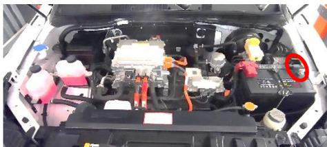
2. Desconecte el sistema de alto voltaje por medio del interruptor ubicado en la parte delantera del vehículo, de esta forma, se deshabilitará la batería de alto voltaje.
