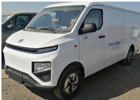
**Sistema de Desactivación Primario:** El vehículo cuenta con una batería de tracción de 334,88 volts, ubicada en la zona inferior de este, la desactivación se debe realizar desconectando el interruptor de alto voltaje, siguiendo las instrucciones del diagrama siguiente, posteriormente se debe desconectar la batería de 12 volts y esperar 10 minutos.
